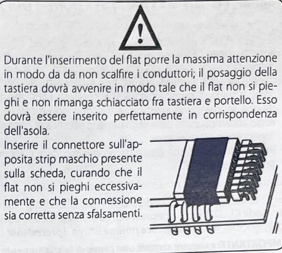
Durante l'inserimento del flat porre la massima attenzione in modo da non scalfire i conduttori; il posaggio della tastiera dovrà avvenire in modo tale che il flat non si pieghi e non rimanga schiacciato fra tastiera e portello. Esso dovrà essere inserito perfettamente in corrispondenza dell'asola.
